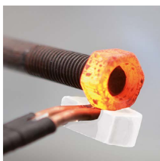
Løsne rustne bolter
