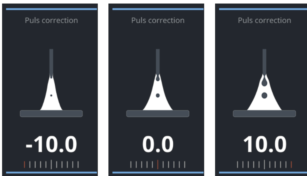
Eksempel: Sveiseparameter Pulskorrigerings -10 / 0 / +10
