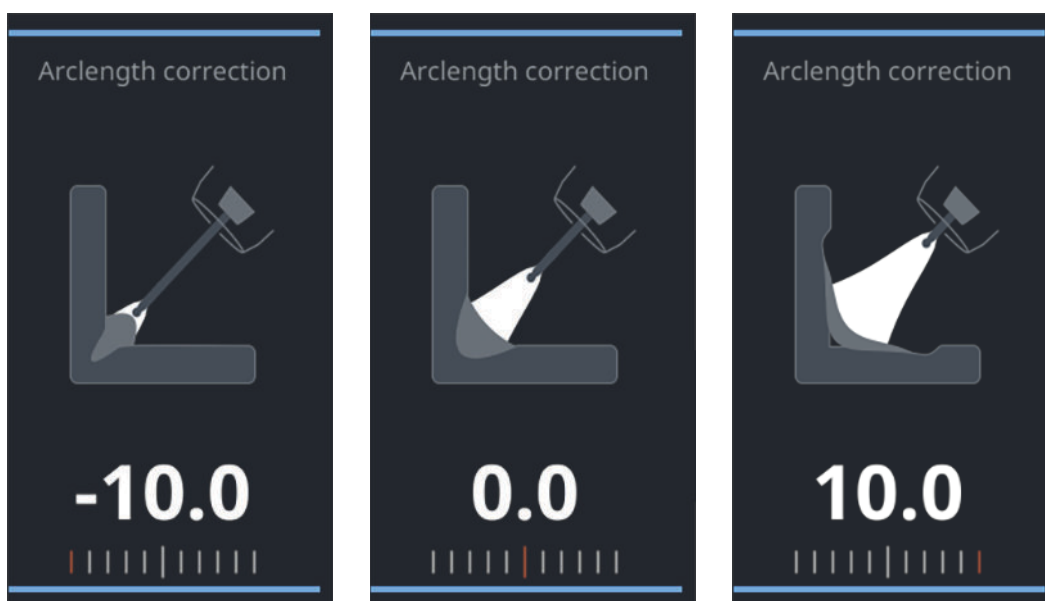
Eksempel: Sveiseparameter Lengdekorrigerings av lysbue -10 / 0 / +10
